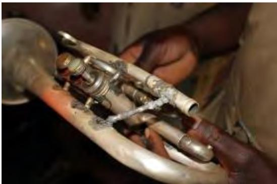
写真-5：古くなって故障したトランペットを溶接
