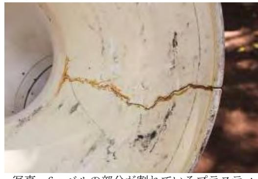
写真-6：ベルの部分が割れているプラスチック製のスナーザフォン
