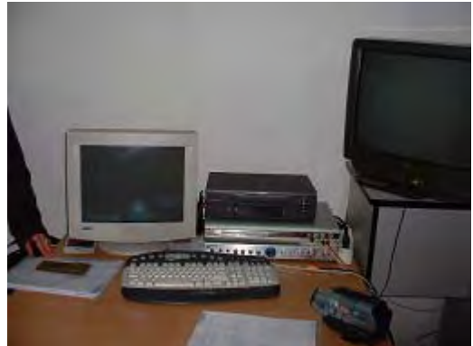
写真-8：既存機材。当該PCでビデオカメラで撮影した映像をデジタル化している。
