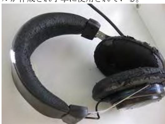
写真-8：使用頻度の高いヘッドホンは劣化が激しい。
