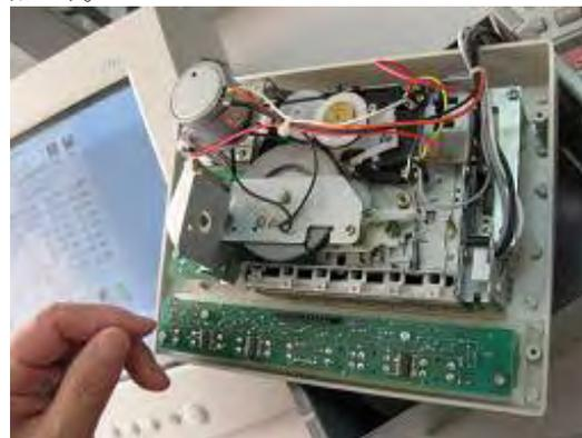
写真-24: 中国LL機材の不具合はプーリー（滑車）のひび割れが原因。
