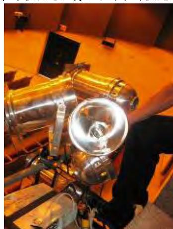
写真-6：パーライトの形状をしたリフレクターライト。光量が不足している上、パーライトであれば球を交換することにより可能なビーム幅の調整が、リフレクターライトではできない。
