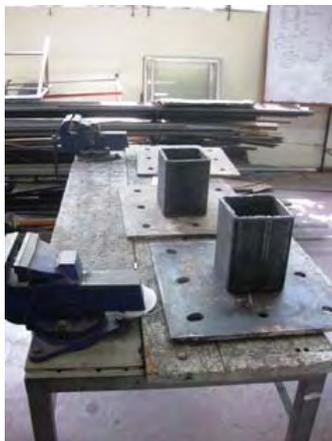
写真-13：舞台上の基礎にボルト止めされるグリッド脚部プレート。大学内で制作された。
