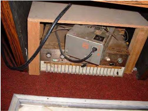
写真-7: 既存のハイインピーダンスアンプ。故障している。
