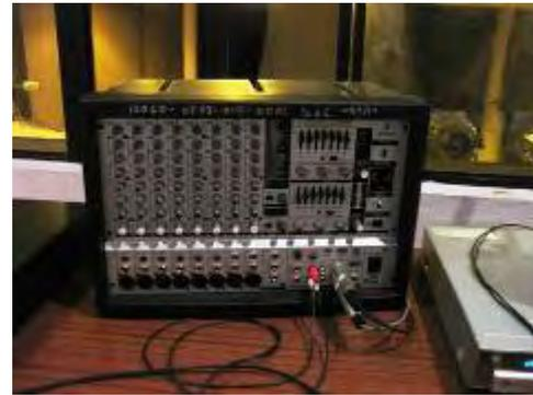
写真-10：ミキサーは故障しており、電源を入れると異臭とともに後ろから煙を発する。修理不可の状態である。
