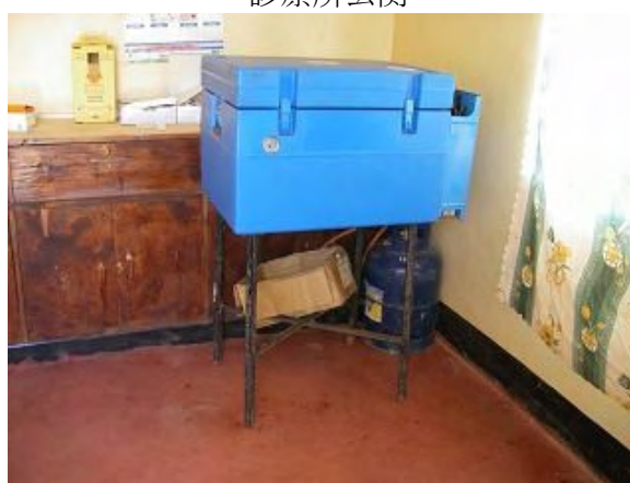
医薬品用冷蔵庫（ガス使用）
