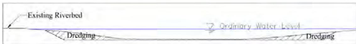
図 R 7.2 浚渫工事の標準断面図
