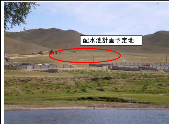
モンゴル側負担事項となる配水池建設の計画地点。標高1,425m付近で斜面が急勾配を呈しており、配水池の建設箇所は、その下部の緩斜面上に計画する。
