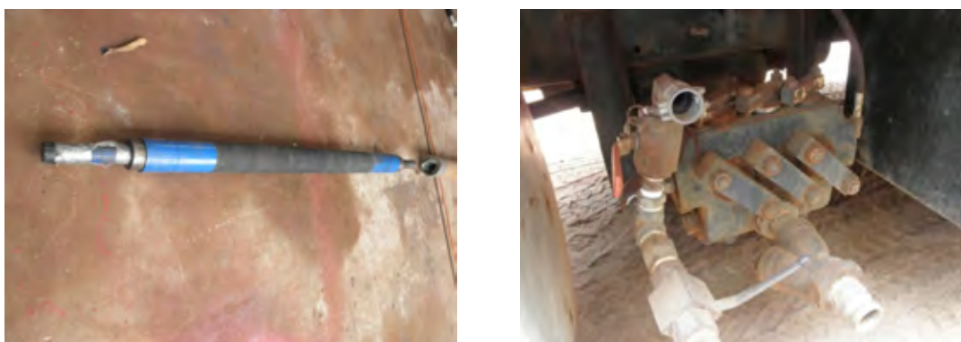
写真 2-12 a (左) , b (右) 水圧破碎用高圧パッカー (左) と 水圧破碎用高圧プランジャーポンプ (右)
