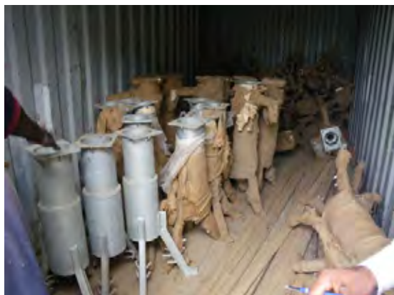
写真 2-1 カラ州支局 コンテナに保管されている人力ポンプ部品 (India Mk III)、概ね利用可能な状態、JICA 第2次無償調達機材、2009/11/03
