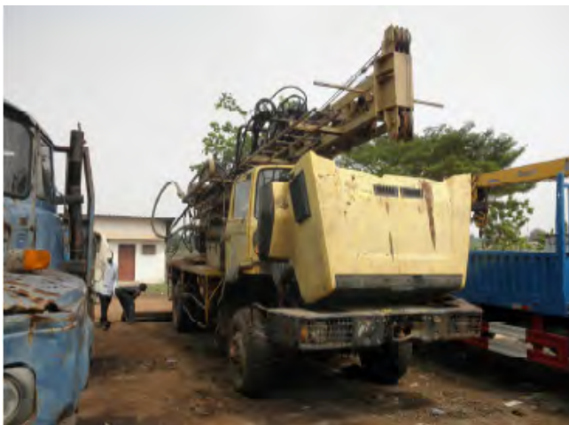
1) 1985年「地下水開発計画（第2次無償）」で調達されたトラック搭載型掘削機（フランス製） 2009/11/23 機動掘削部隊
