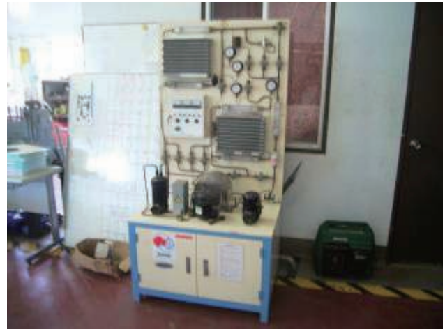
機関部門のワークショップ。冷凍機の訓練用モデルなど、様々な訓練教材があり、機関実習に用いられている。
