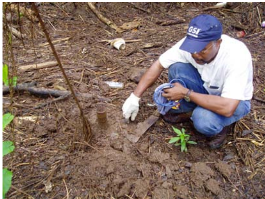
バルバドス政府が独自予算により洪水調整池に 設置した水位観測機を取り出しているところ。
