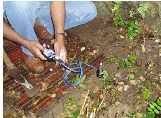
左記水位観測機に記録された降雨時の水位を 専用の機器で読み取っているところ。
