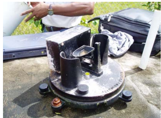
プロジェクトで支援した降雨量観測機で 記録された降雨量を読み出すところ。 (この日は PC の不具合でうまく行かなかった。)
