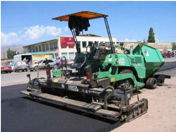
「ナリン建機道路維持管理用機材整備計画」（無償）にて調達され、再舗装作業中のアスファルトフィニッシャー
