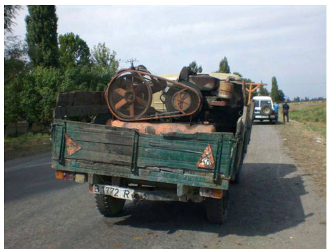
パッチング作業用トラック 25 年以上使用し、老朽化のため故障が多く、稼働効率が悪い。
