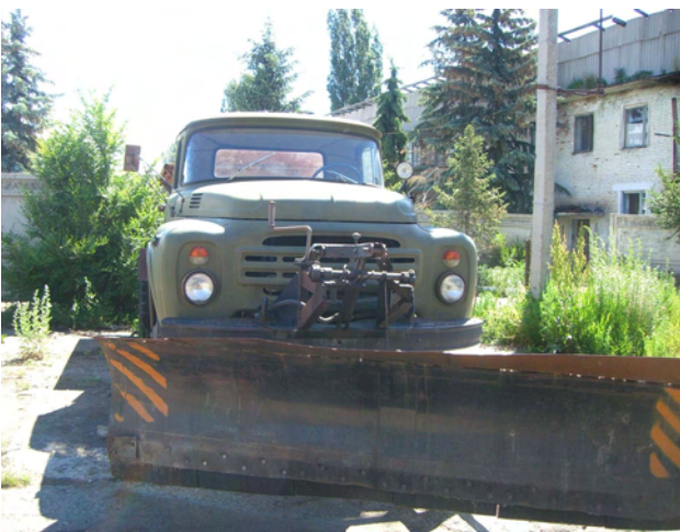
普通ダンプに除雪ブレードを装着した除雪用トラック。30 年以上前の機材で老朽化し、作業能力も低い。
