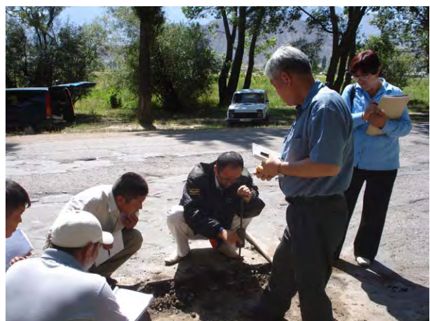
「道路維持管理能力向上プロジェクト」（技プロ）にて実施された路盤調査実習
