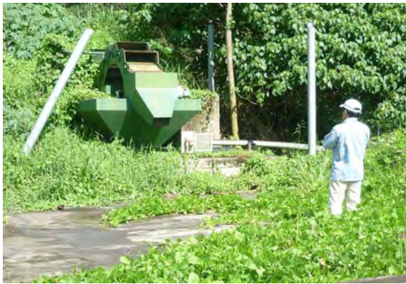
EUが供与した砂洗浄機 洗浄に時間がかかり2回で 放置された
