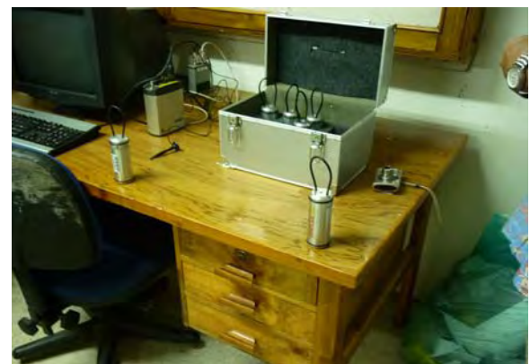
漏水発見用の音波探査器
