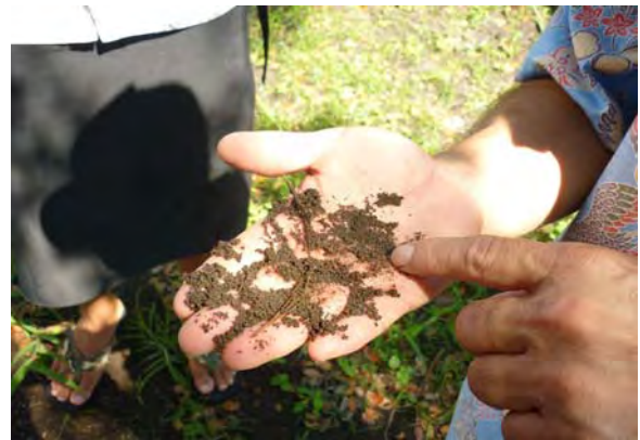
ろ過地に使う砂 河川のものを使っている
