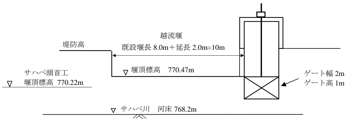
図 3-2-2-1 洪水放流工の改修方針
