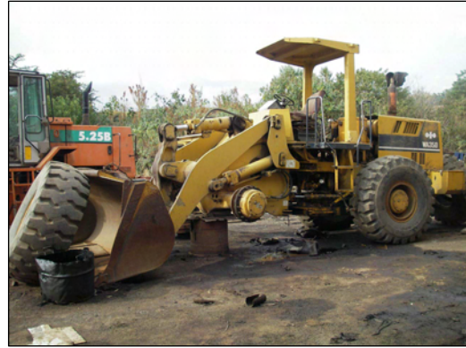
修理のための部品待状態のホイールローダ。修理が終わり次第、アバイ渓谷以外の道路維持現場に派遣される予定となっている。
