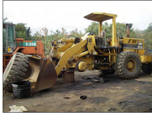
修理のための部品待状態のホイールローダ。修理が終わり次第、アバイ溪谷以外の道路維持現場に派遣される予定となっている。
