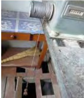
写真 2-3-3 カイラクム貯水池ハイδροポスト (自記水位計)
