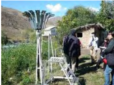
写真 2-2-21 トレチャノフ雨量計 (手前)、セリヤ ーノフボックス (奥) (ハイドロポスト-6)
