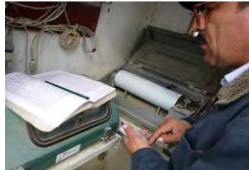
写真 2-3-6 シルダリア-キジルキシラクハイ ドロポスト自記水位計
