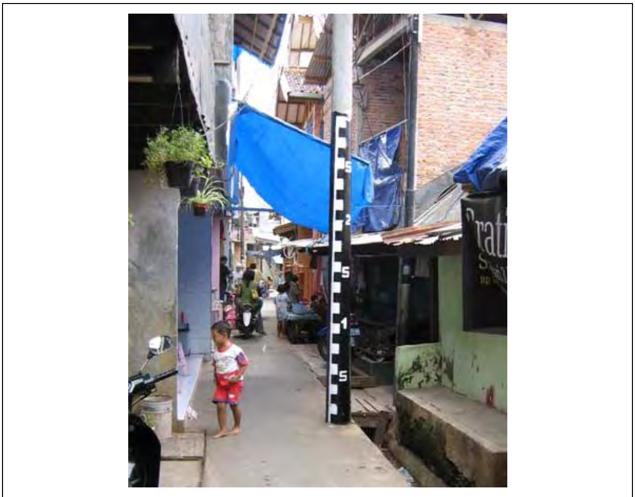
写真-2.3 カンボンムラユ地区に設置された量水標
