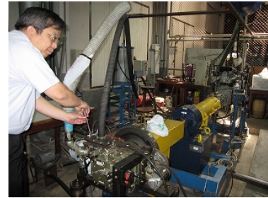
工学部機械工学科の内視鏡付き エンジン運転試験装置
