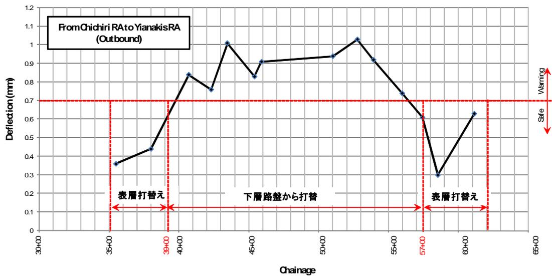
表 3-3(1) ベンゲルマンビーム試験結果および舗装補修方法と適用範囲
