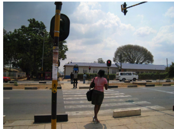
写真 3-2-5 新規型横断歩道 1期工事で採用した幅員3mの横断歩道で 運転手からの視野が高くなった。
