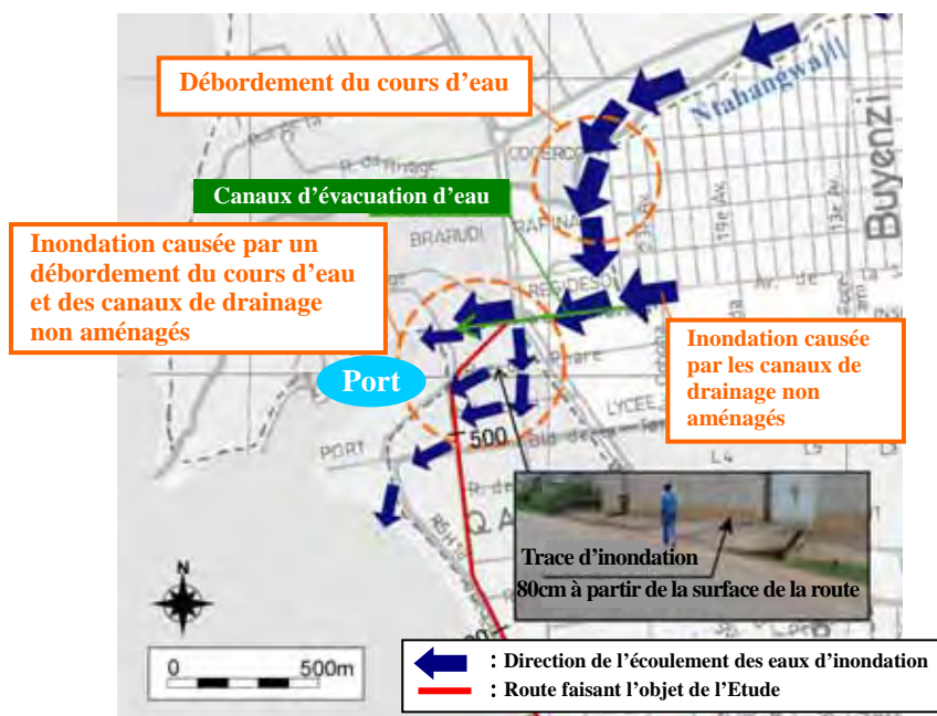
Fig.2-2-1-3.1 : Situation des inondations au point de départ
