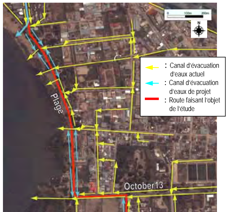
Fig. 2-2-2-3.3 : Plan de réseau d'évacuation d'eaux de l'Avenue de la Plage et de l'Avenue du 13 Octobre
