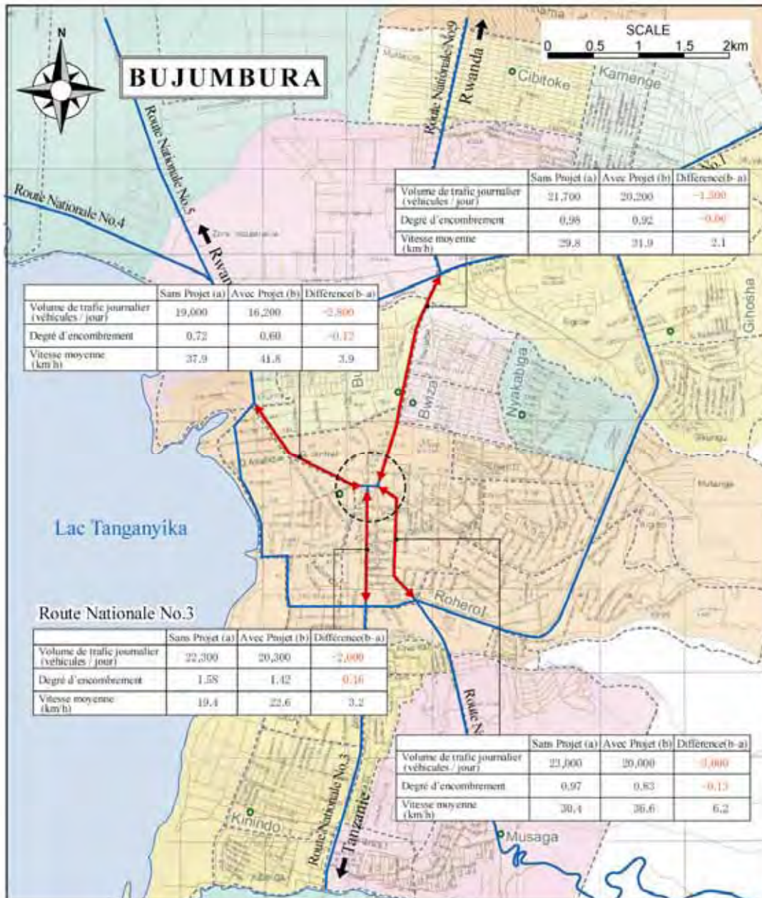
Fig. 2-2-1-8.4 : Situation de la circulation des quatre axes traversant la ville (en 2012)
