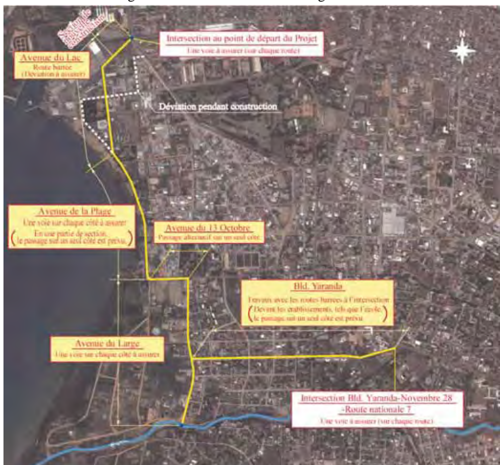
Fig. 2-2-4-2.2 : Forme de l'occupation des routes pendant les travaux
