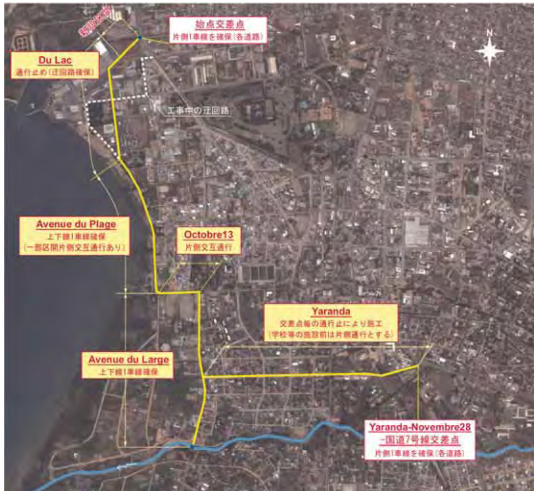
図 3-2-4-2.2 工事施工時の道路占用形態
