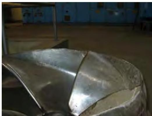
写真 R 2-1.5 ステンレス製インペラーの損傷状況（ココロードポンプ場約 4 年間使用後）
