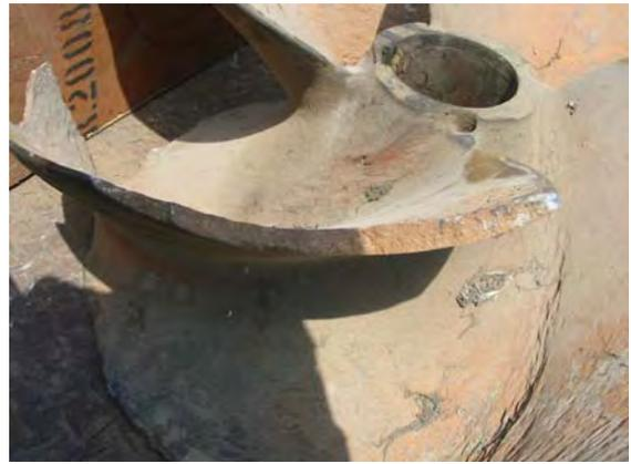
写真 R 2-1.3 鋳鉄製インペラーの損傷状況（P-1 ポンプ、約 10 年間使用後）
