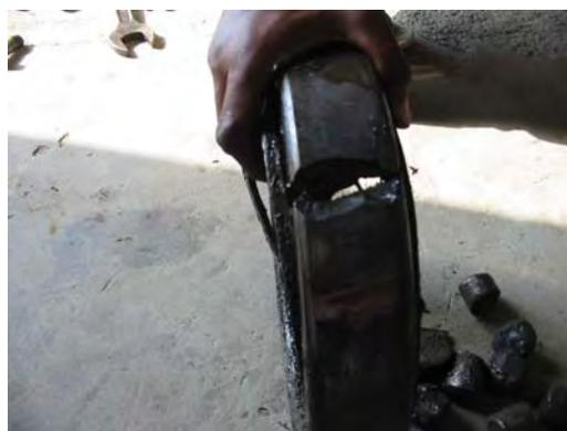
写真 R 2-1.6 ココロードポンプ場のポンプベアリングの破損状況
