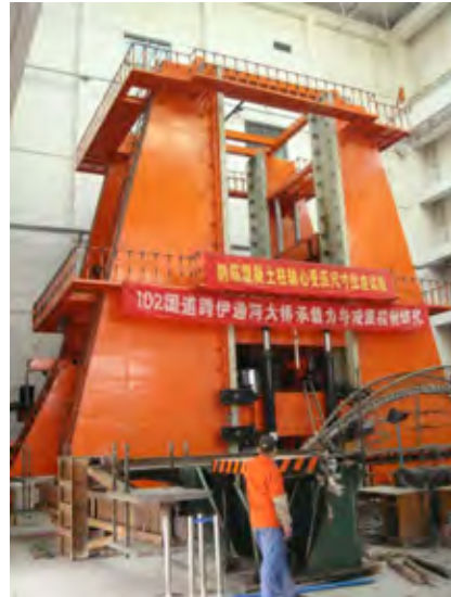
免・制震機器用試験機 (鉛直 4,000t、水平 400t 加力)
