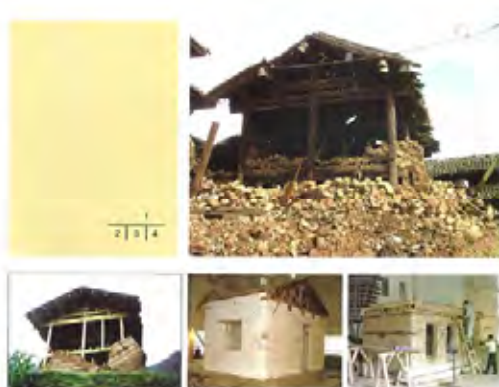
写真2-10 農村住宅耐震性研究 （被害調査と震動台実験）
