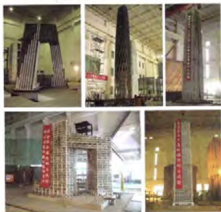
写真2-9 超高層ビル耐震性研究 （震動台実験）
