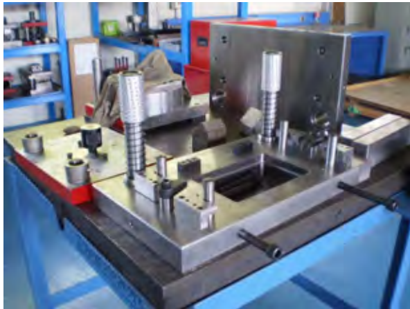
CIDESE-C/P 設計製作のクイックダイチェンジ（左）とリンクモーションプレス機（右）
