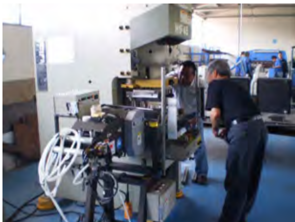
サーボプレス機への金型設置作業の指導
