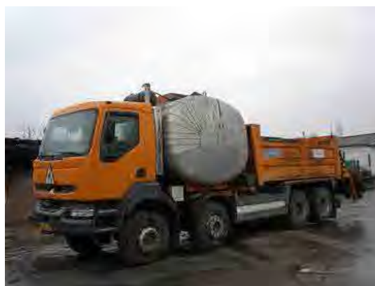
フランス製簡易舗装機
