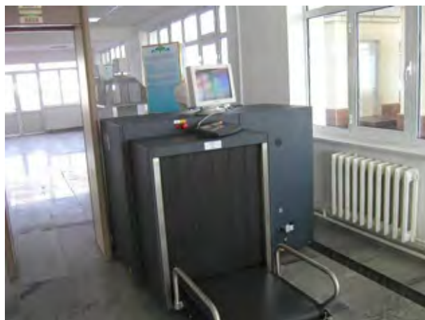
写真-4: 手荷物用 X 線検査機材ほか 越境する人は、金属探知機(写真左手の門型の装置)による金属探知検査、所持している荷物については手荷物用 X 線検査機材 (Smith Heimann 製、HS7085 型) による、X 線検査が行われる。
