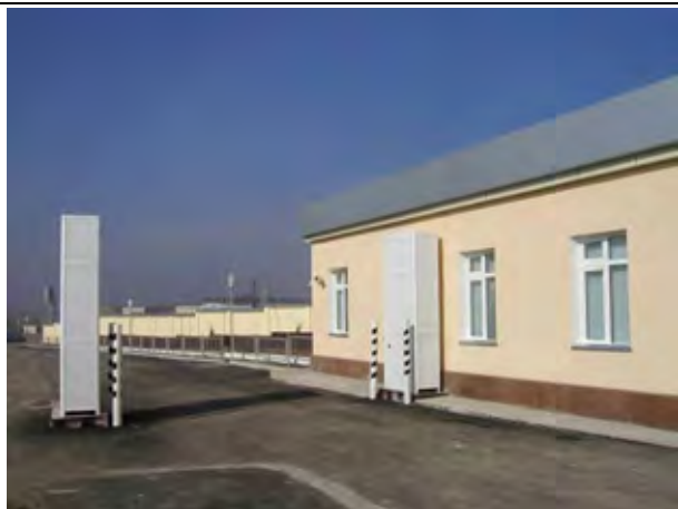
写真-3: 放射線検査 ポータルモニター(写真の白色の四角柱の中に設置されており、ロシアのAspekt製Yantari-2A型で米国の供与)により、越境するトラックやコンテナなどの車両を通過させて、ウラニウムなどの放射性物質の有無を監視している。
