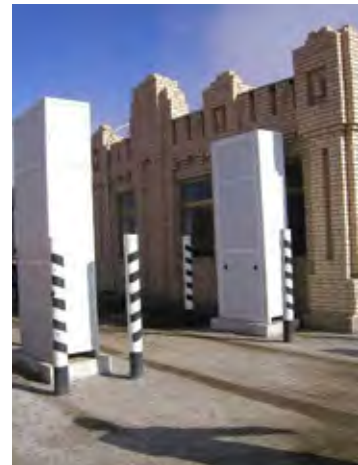
写真 - 4 : 放射線検査 ポータルモニター(写真の白色の四角柱の中に設置されている)により、越境するトラックやコンテナなどの車両を通過させて、ウランウムなどの放射性物質の有無を監視している。ロシアのAspekt製のYantari-2A型で米国から供与された。
