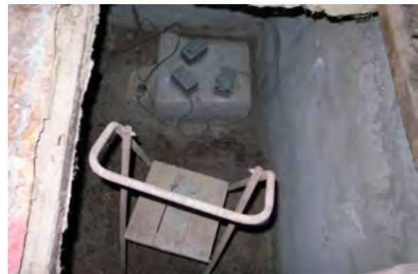
同左。地震計設置状況。地下水が上昇し、地下の床が数 cm ほど水につかることがある。
