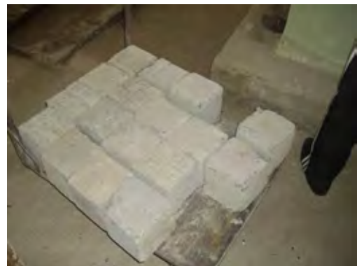
耐震建設研究所。コンクリート・構造研究室の試験所に置かれた試験用コンクリートサンプル。
