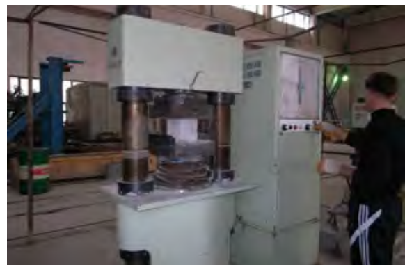
耐震建設研究所。コンクリート・構造研究室の試験所建物に設置されたコンクリート圧縮試験機器。
