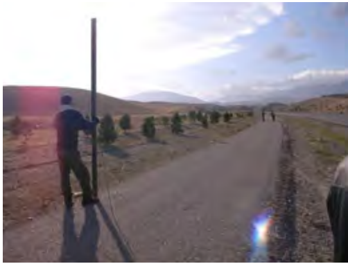
アシガバット予知予測エリアでの観測。 アシガバット - バハルダック測線での水準 測量の状況。
