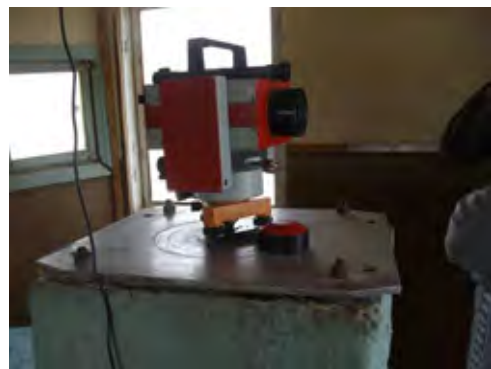
同左。レーザー測距機器。以前使用していた の機器(左下写真)より測定可能距離が短い。
