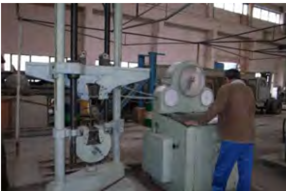
耐震建設研究所。コンクリート・構造研究室の試験所内に設置された鉄筋引張試験器。
