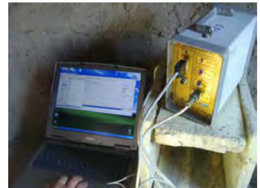
同左。 現地において RS232C を経由した観測波形の確認の実施状況。
