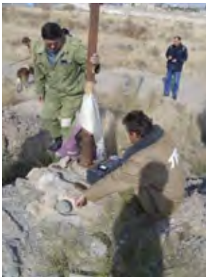
アシガバット予知予測エリアでの観測。 ボーリング孔内での地下水の電気抵抗、水 温、水位の観測状況。
