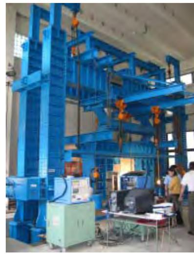
図 2 加力実験システム
