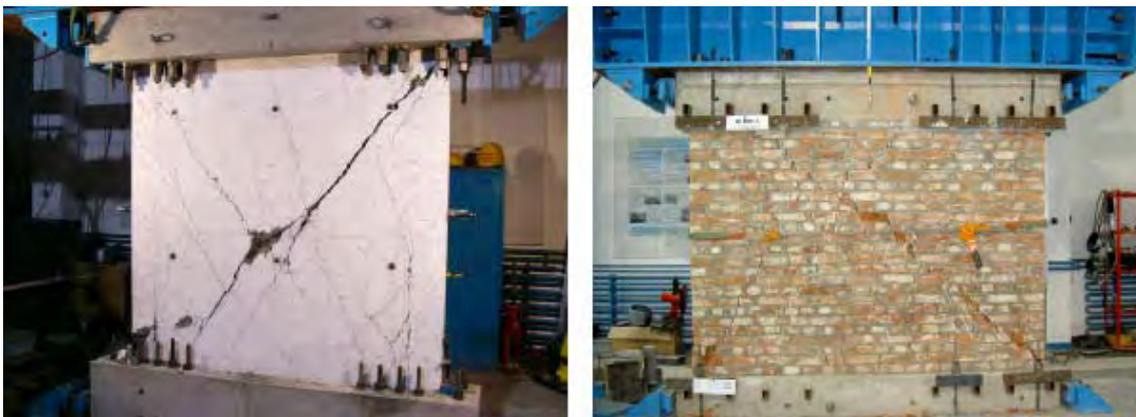
図 3 RC 壁及び RC 造架構にレンガ造壁を組み込んだ試験体の実験
