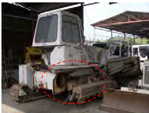
中型（10 トンクラス）ブルドーザーの駆動部 駆動ギアや無限軌道が部品取りされている。
