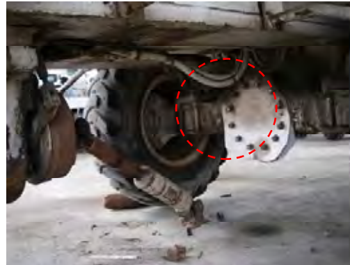
ホイール式バックホウのデフ駆動部 デフ部のギアが部品取りされている。
