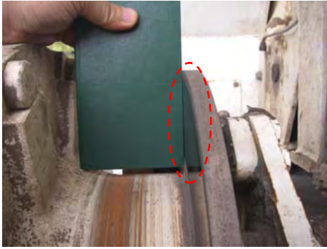
ホイールローダーのブレーキ部。 ディスクの大きな摩耗は見られない。
