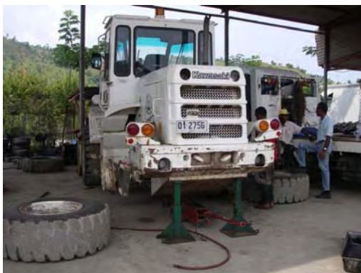
ホイールローダーの修理状況（部品交換）。 駆動部のダンパー交換状況。
