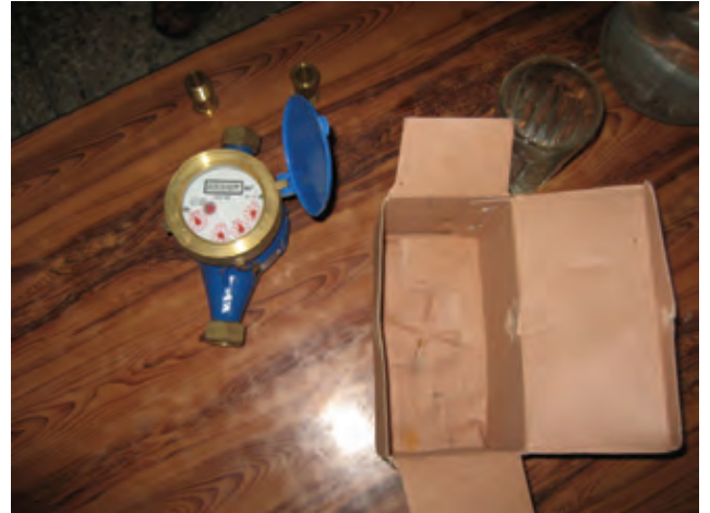
ナワンシェールサービスユニットでは、故障した水道メーターを随時、新品と交換している。写真はパキスタン製水道メーター。ISO 規格品で値段は 1,000 ルピー程。
