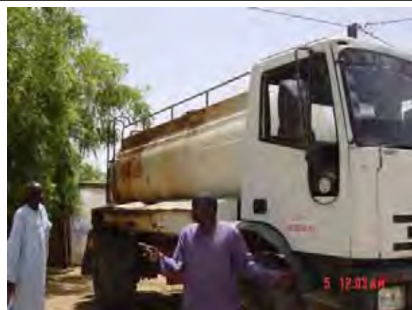
写真-9 トゥーバ BPF 保有の老朽化した給水車 現在も稼働しているが、老朽化が著しく、エンジンの燃費も著しく劣化している。
