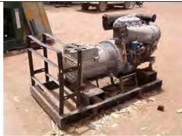
写真-6 カオラック SM のコンプレッサー 老朽化し稼動しなくなったために、分解され、パーツが別 の機材の修理用として用いられている。
