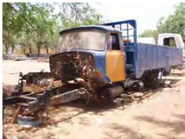
写真-8 タンバクンダ SM のトラック 数年前に故障した当該トラックは、分解され、必要な部品が他の車両のスペア・パーツとして取り出されている。
