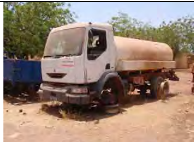
写真-5 タンバクンダ SM の給水車 老朽化のため稼動しておらず、使えるパーツはポンプホ イスト車の修理に用いられた。
