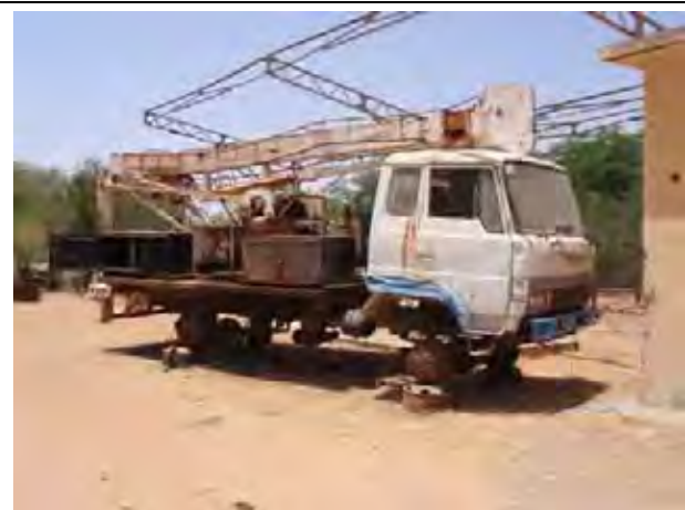
写真-3 ルーガ SM のポンプホイスト 当該車両は使用年数が 10 年を超えており、故障が頻発す るために現在は全く使用されていない。
