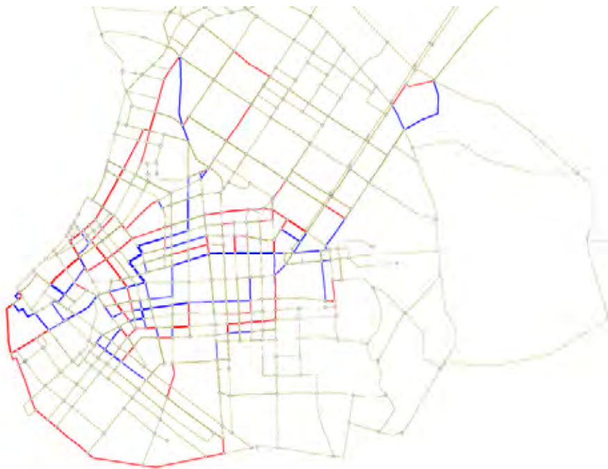
図 9.1-5 工事中ケースと通常時との交通量差: セントロ区間工事
