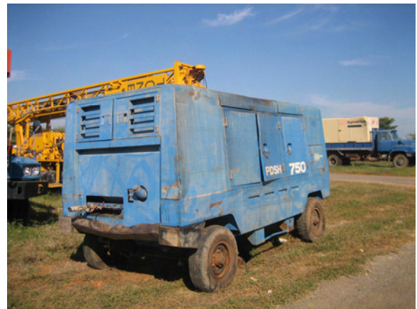
都市飲料水開発計画（無償、1986）にて調達されたコンプレッサーを修理し、使用している
