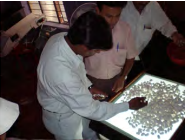
繭市場に導入された繭質評価のための機器① 不良繭を選定している。
