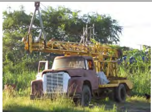
写-4 UNASBVI の車載型掘削機械 -使用不能
