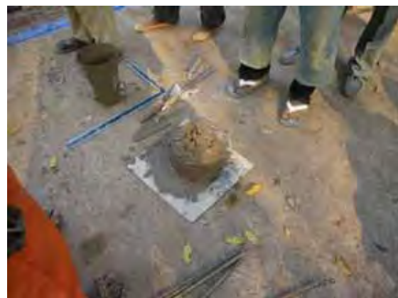
コンクリートのスラブ試験
