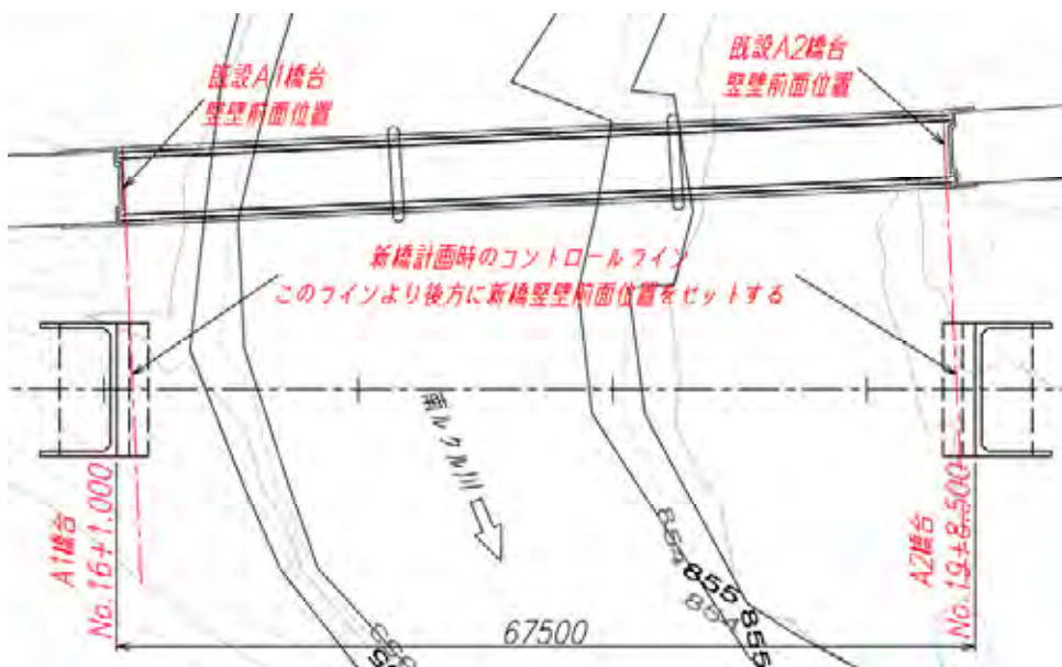
図 3-2-22 新橋橋台位置 (最低限必要な橋長)
