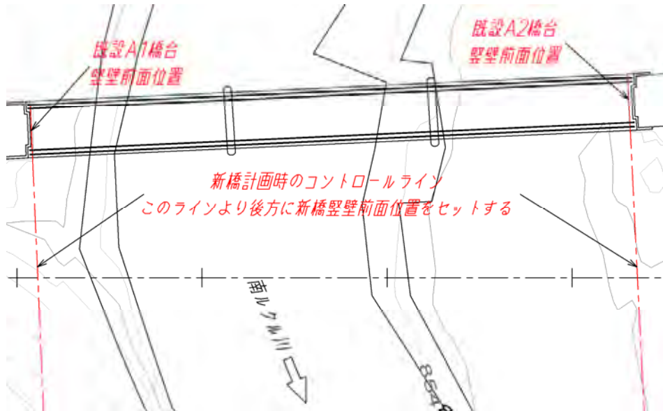
図 3-2-21 新橋梁計画時のコントロールポイント
