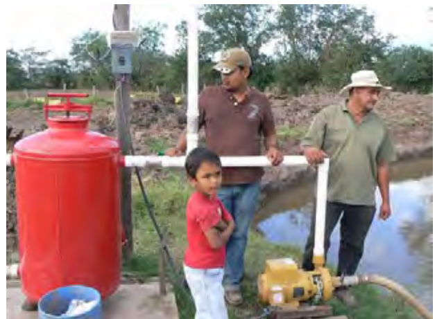
コマヤグアの FINTRAC の技術支援を受けた 農家の点滴灌溉用のポンプとフィルター
