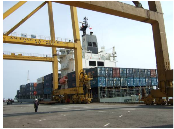
写真2 ダナン港のコンテナ埠頭。40tクレーンによるコンテナ荷降ろしの様子。
