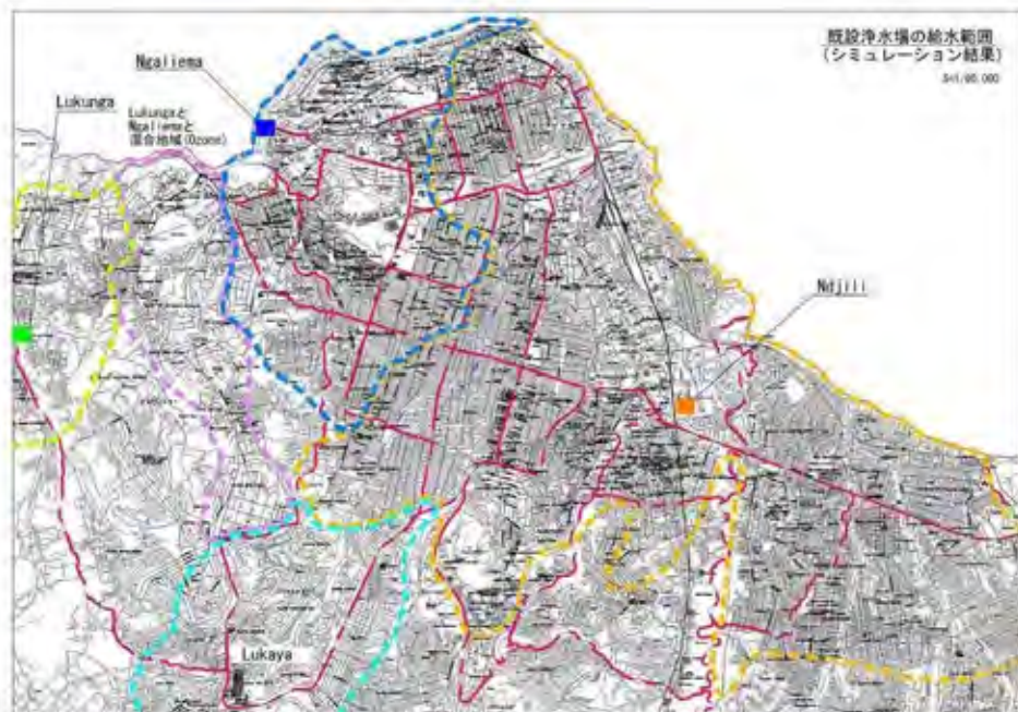
図-1 管網解析結果による各浄水場の給水範囲
