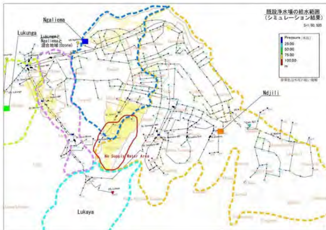
図-3 管網解析結果による水圧分布図 茶色の範囲は水圧不足のエリアを示す。
