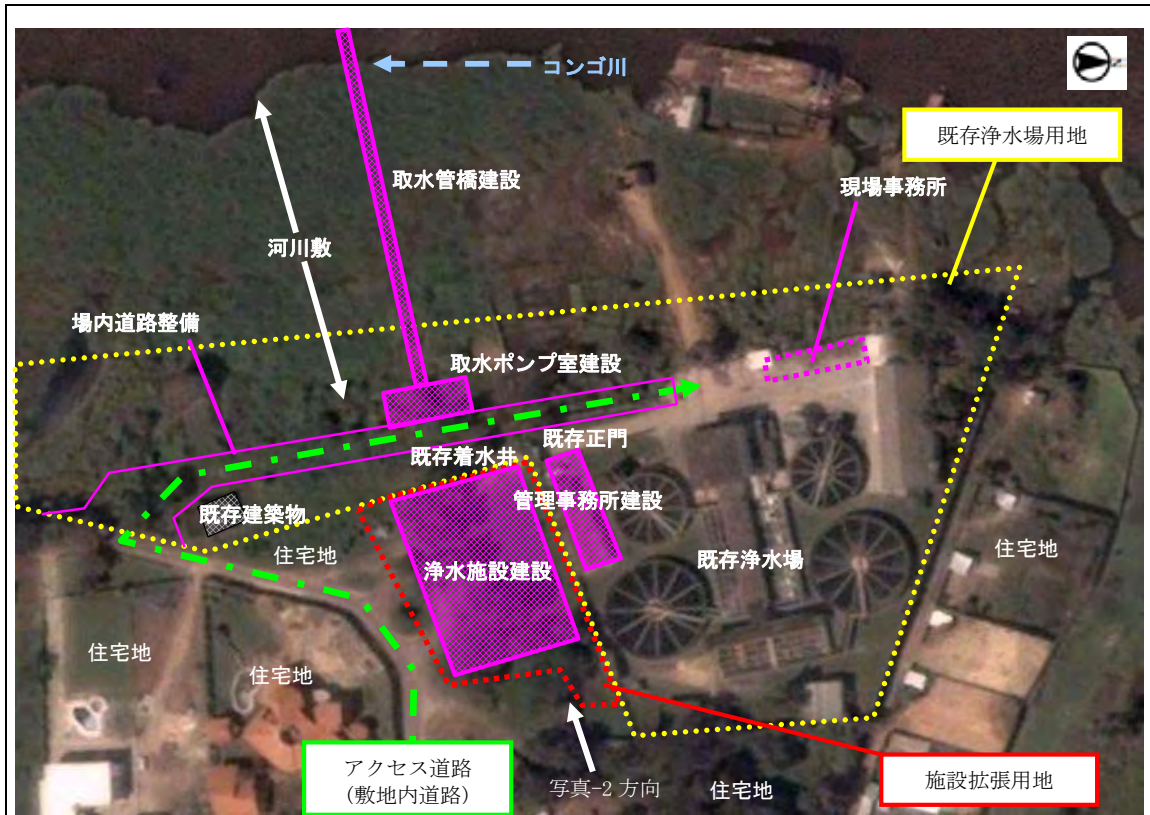
写真-1 現況施設及び拡張施設の配置計画
