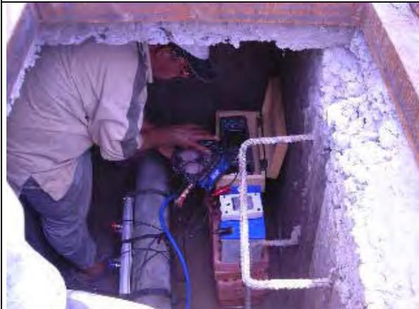
ザガジグ郡で夜間最小流量調査のポータブル流量計を設置している状況。
