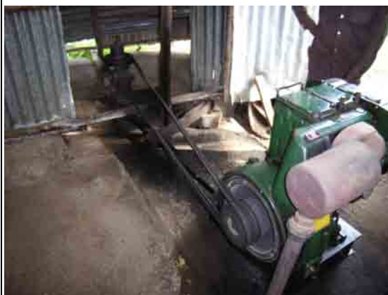
写真-2 (撮影;基本設計調査) : 地下水位の低い箇所が多く利用されているモノポンプとリスターエンジン
