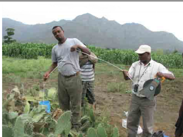
写真-18（撮影;事業化調査）：ラヤ・アゼボ郡ドドタ集落で掘削した試掘井戸調査。井戸に堆砂がみられるので、井戸洗浄が必要である。
