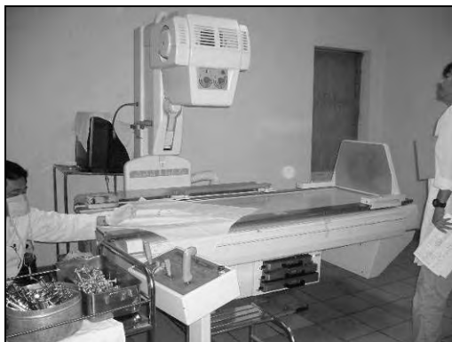
画像診断部門（H棟1階） 既存の透視撮影装置。高圧発生装置を一般撮影と兼用している。
