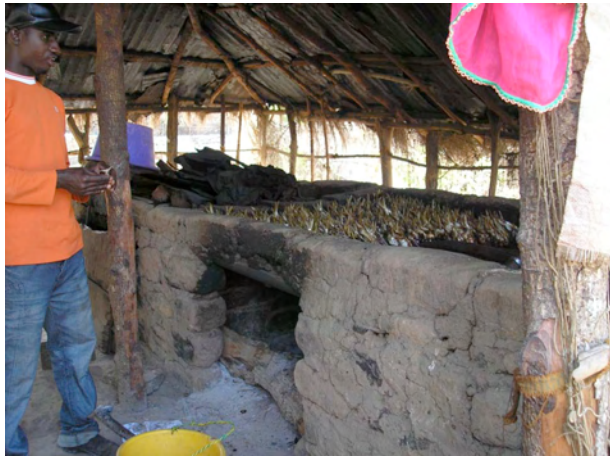
カシーン村家庭内の薫製カマ：各家庭で薫製作業を行っているが、薪燃料の消費量が多く改良が必要である。
