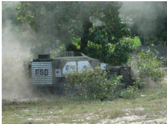
写真-31 : 地雷処理車の使用状況。深さ 30cm までを掘り返してゆく。ただし 4t 重量のため軟弱地盤では作業できない。
