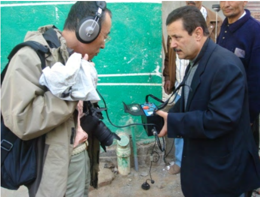
漏水探知機：広範囲を対象として漏水箇所のスクリーニングを行う。漏水が疑われる給水管を特定したのちに、音聴棒により漏水の有無を確認する。
